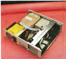
Guscio della CPU del computer aperto. Nella parte inferiore disposizione delle schede di espansione
